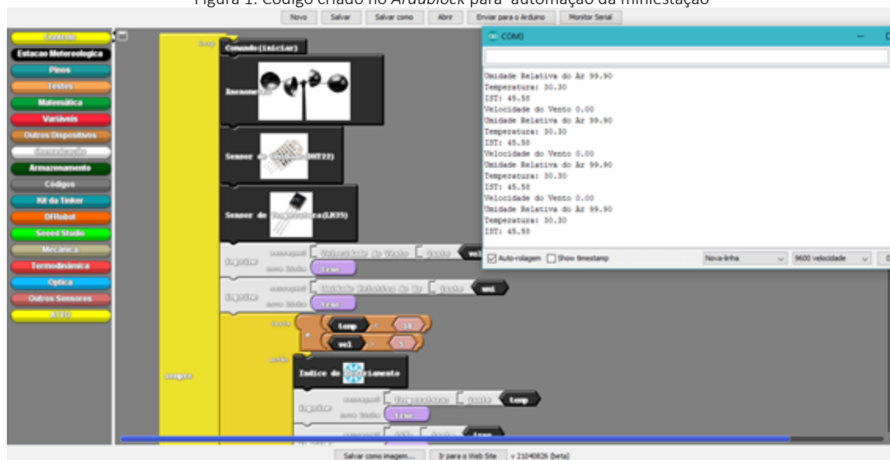
Figura 1. Código criado no Ardublock para automação da miniestação
